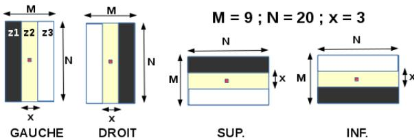
FIGURE 2 – Masques pour la détection des bords du ticket
