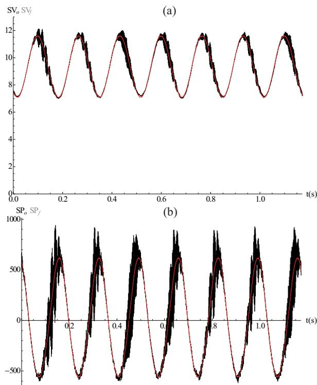
FIGURE 8 – Signaux mesurés pour  $U = 20$  m/s et un champ infrasonore à 6 Hz. (a) vitesse à l'entrée  $V_o(t)$  (noir) et terme de forçage  $V_f(t)$  (rouge) en m/s ; (b) pression acoustique  $P_o(t)$  (noir) et terme de forçage  $P_f(t)$  (rouge) en Pa.
