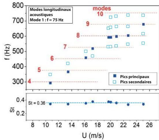
FIGURE 6 – Réponse du tuyau corrugué à un écoulement. Fréquences de sifflement pour diverses vitesses d'écoulement et nombres de Strouhal correspondant  $St = f(w + r)/U$
