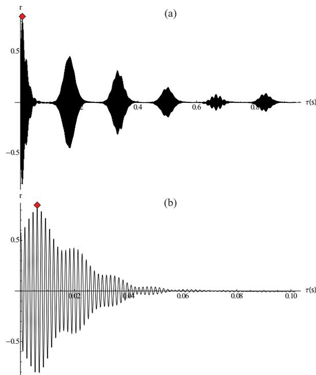
FIGURE 11 – Coefficient de corrélation de Pearson  $r$  entre  $V_c(t)$  et  $P_c(t + \tau)$  pour  $U = 20$  m/s et un champ infrasonore à 6 Hz. (a) : délai  $\tau = 1$  s; (b) : délai de  $\tau = 0,1$  s.
