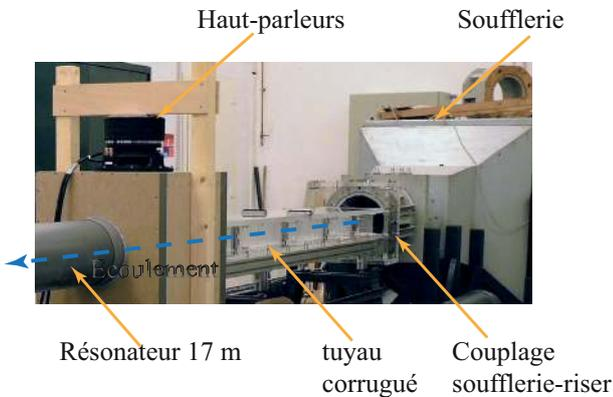
FIGURE 1 – Dispositif expérimental. Soufflerie, tuyau corrugué et haut-parleur.
