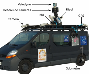
Figure 6. Vue d'ensemble du véhicule d'acquisition Stéréopolis.
