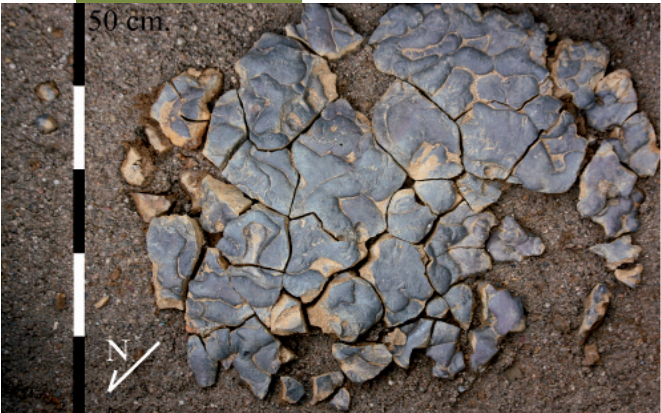
Un objet rare : une coulée complète de scorie chargée de silicates et d'oxydes de fer
