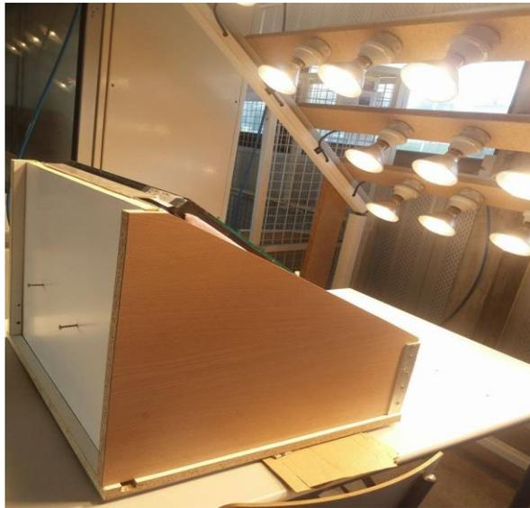
Figure 6 : Photographie du distillateur solaire et du banc d'éclairage
