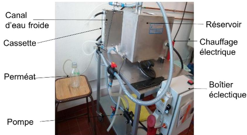
Figure 3 : Photographie de l'installation de distillation membranaire
