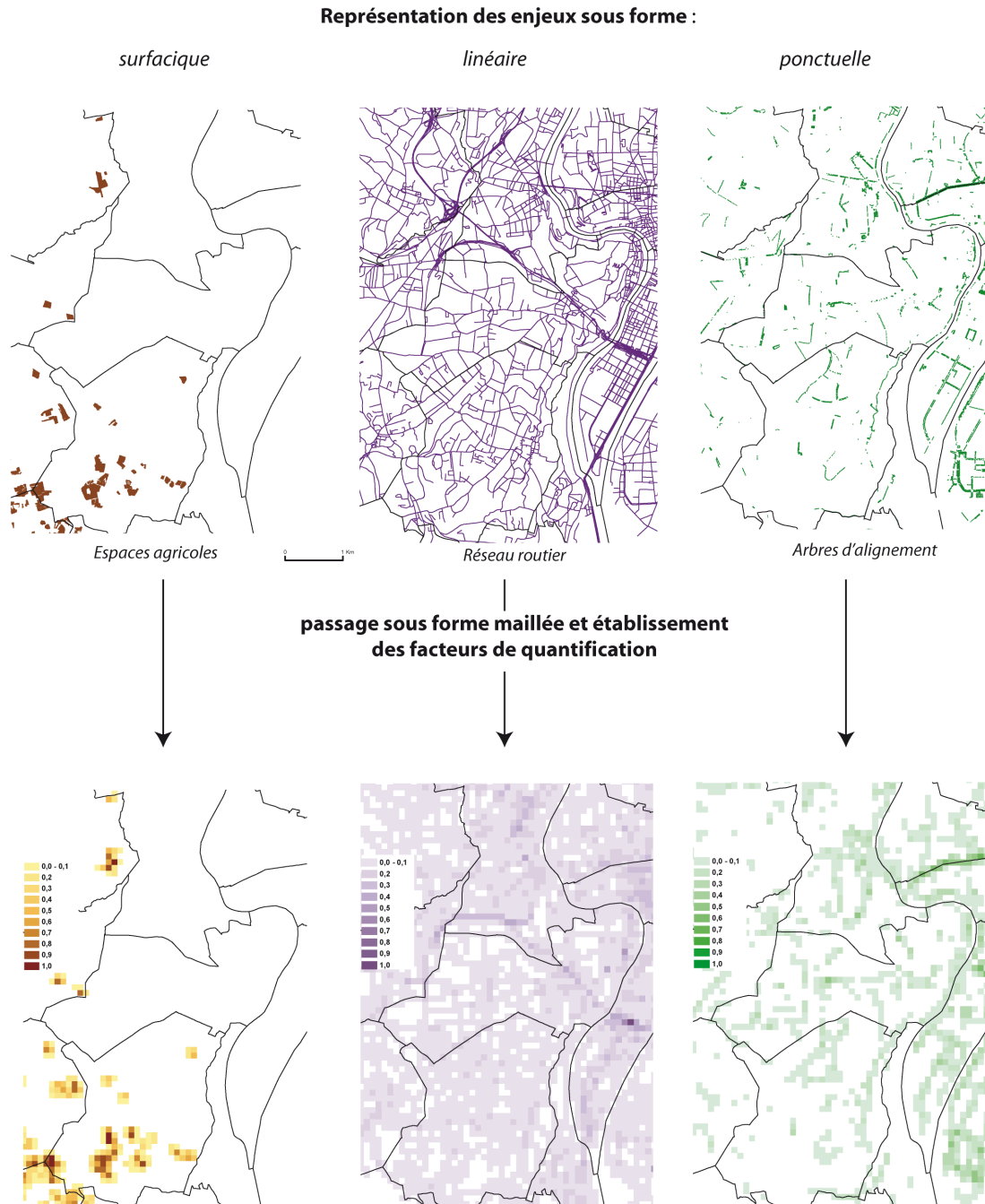
Figure 4. Exemple de conversion d'enjeux représentés respectivement sous forme surfactive, linéaire et ponctuelle à une forme maillée.
