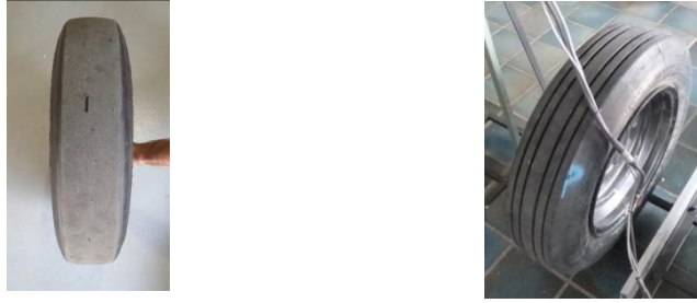
Fig. 3 Photographies du pneumatique AIPCR (gauche) et du pneumatique d'avion utilisé lors des essais (droite) Picture of a PIARC test tire (left) and the aircraft tire used in the testing (right)
