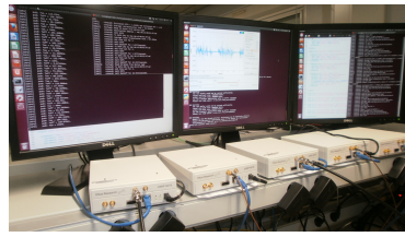
(a) 5 USRP connectés par une matrice RF
