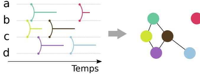
FIGURE 1: Transformation d'un flot de liens avec 4 nœuds (a-d) et 6 liens à gauche en un graphe à droite à 6 nœuds. La couleur d'un nœuds dans le graphe indique le lien du flot qu'il représente.
