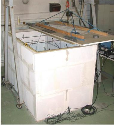
FIGURE 5 – Maquette 1/5<sup>eme</sup> de la salle anéchoïque
