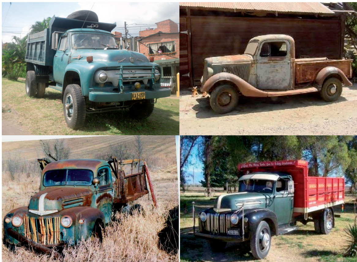
Figura 2. a) Camión Ford 54 con tolva “de volteo”; b) Camión Ford 35, con motor en V de 8 cilindros, carga cuatro toneladas. Común en las flotas llareteras en los ‘40 y ‘50, c) y d) Camión Ford 46, el primero en aprovechar la “máquina de caminos”.
