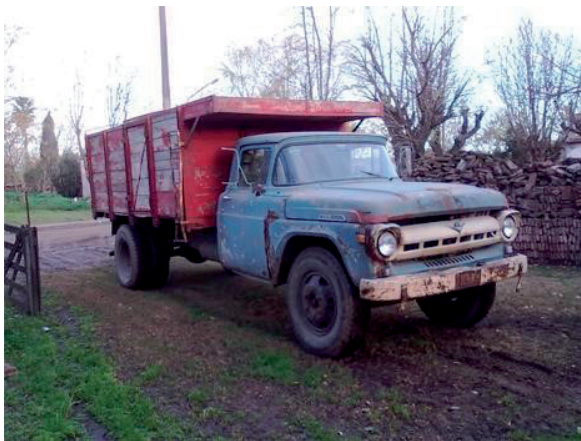
Figura 3. a) y b). Camiones Ford 600, con caja de cambios de 5 marchas. La parte trasera con estacas fue característica, desde fines de los '60, para transporte de pasajeros. Entre 1962 y 1974, con motor bencinero; de 1974 a 1983, con motor bencinero (V8) o diesel de cuatro tiempos, y a partir de 1983 solo en versión diesel.
