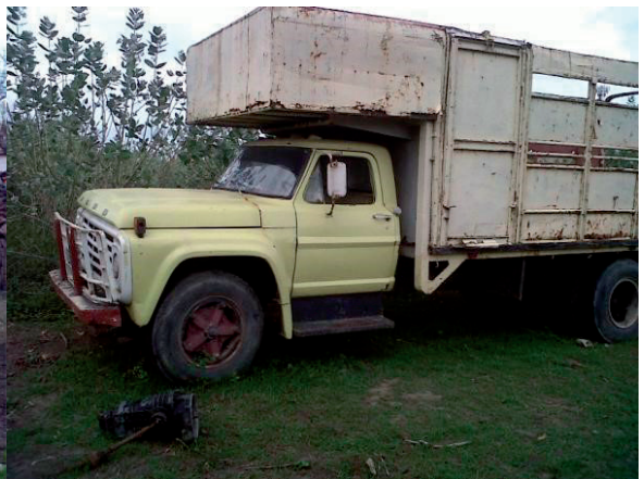
Figura 3. a) y b). Camiones Ford 600, con caja de cambios de 5 marchas. La parte trasera con estacas fue característica, desde fines de los '60, para transporte de pasajeros. Entre 1962 y 1974, con motor bencinero; de 1974 a 1983, con motor bencinero (V8) o diesel de cuatro tiempos, y a partir de 1983 solo en versión diesel.
