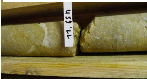
Graphique 5: Exemple de fissure colmatée sous le contact avec la fondation et de fissure ouverte en fondation
