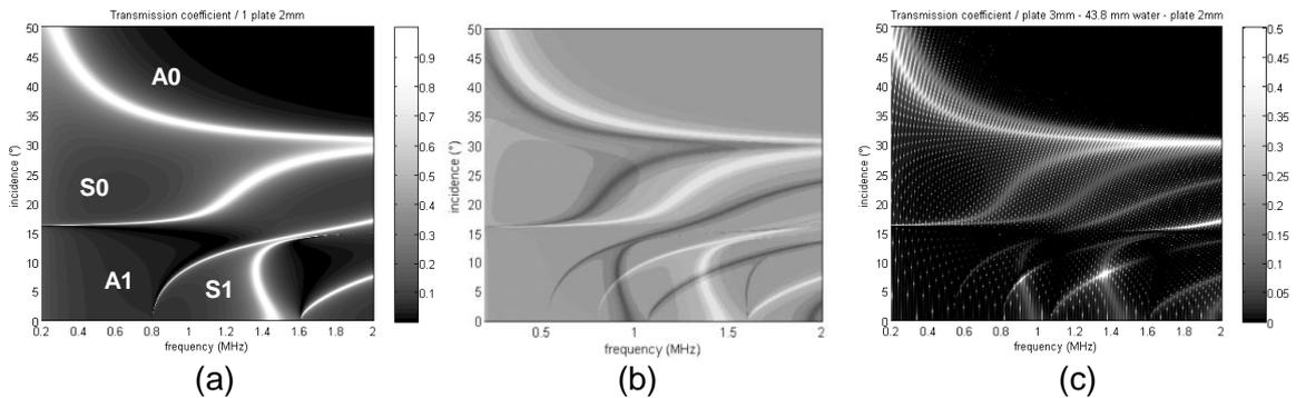
Figure 3 : Coefficients de transmission théoriques : (a) pour une plaque d'acier de 2mm d'épaisseur, (b) pour une plaque d'acier de 2mm et une de 3mm individuellement, superposés graphiquement, (c) pour un système avec une plaque de 2mm et une de 3mm séparées par 43.8mm d'eau.
