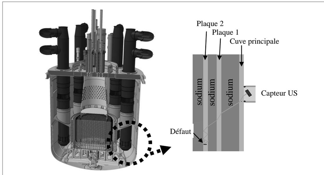
Figure 1 : Inspection depuis l'extérieur du milieu sodium
