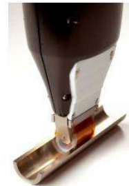
Capteur conforme (courants de Foucault) (CEA LIST 2009)
