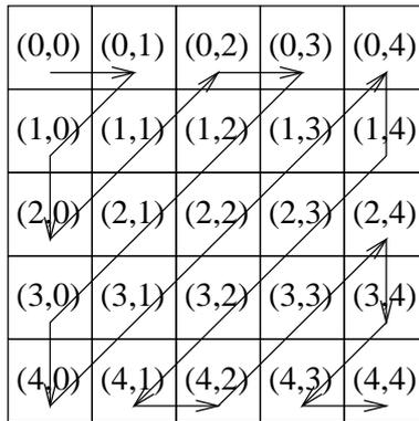
FIG. 4: Le parcours en zigzag d'une matrice
