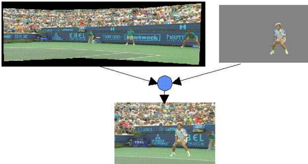
FIG. 14: Exemple de codage basé sur le contenu de vidéos naturelles en MPEG4
