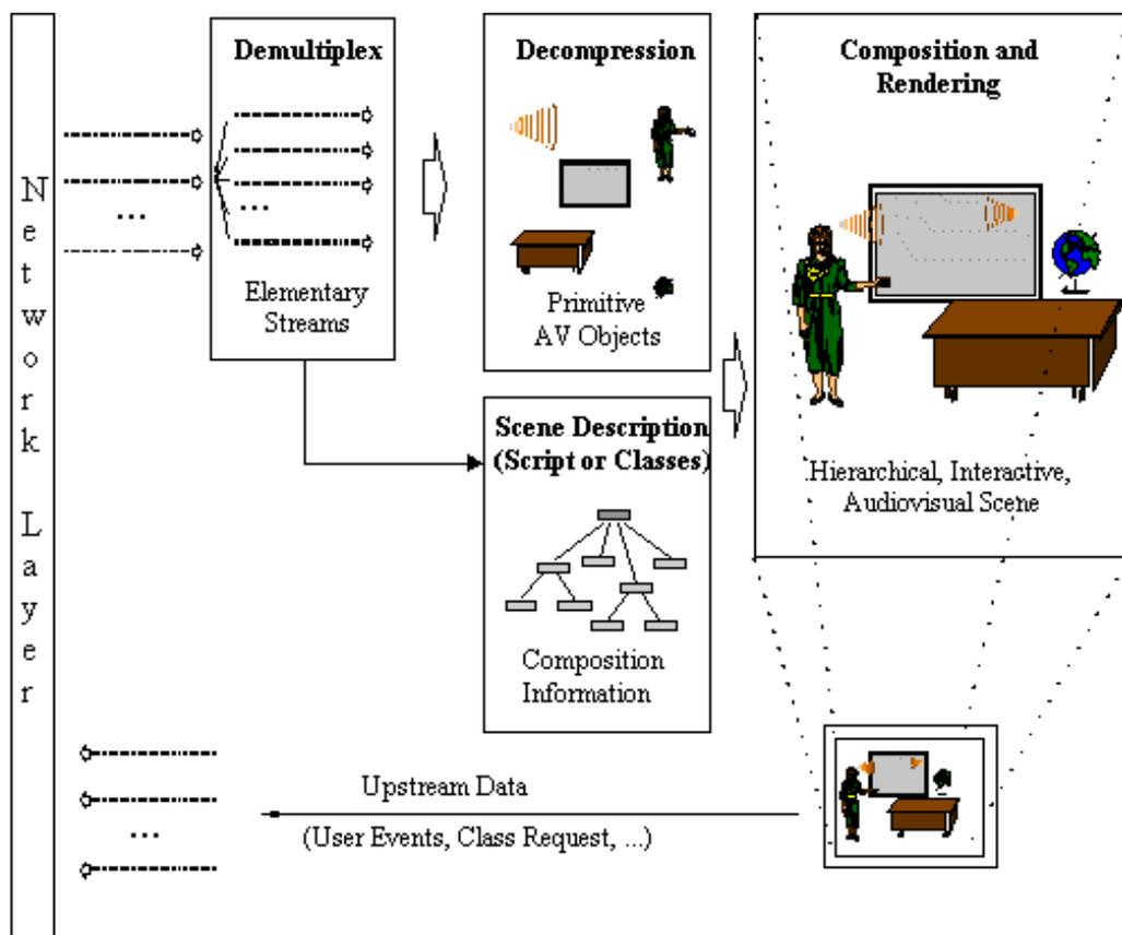
FIG. 11: Un système MPEG4 complet
