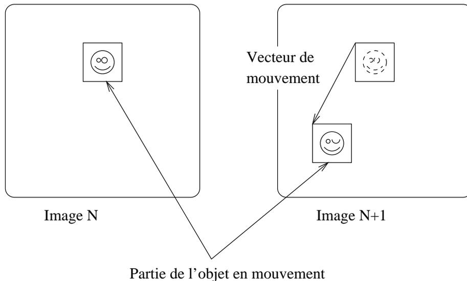
FIG. 6: Le principe de la compensation de mouvement
