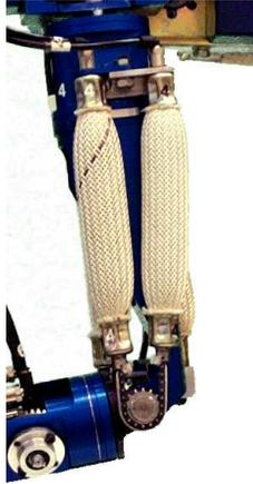
FIG. 11 – Détail d’une articulation actionnée par des muscles artificiels de McKibben
