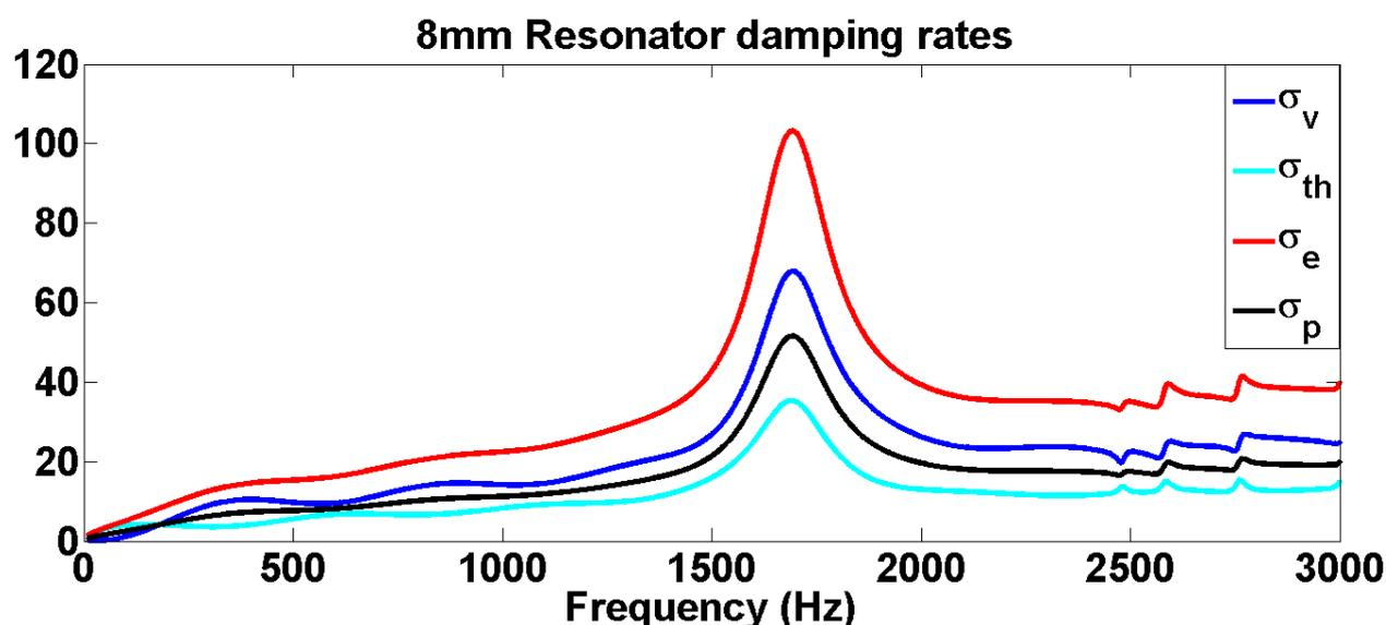
Figure 1 : taux d'amortissement : rouge) taux d'amortissement d'énergie, bleue) sa contribution visqueuse, cyan) sa contribution thermique, noire) taux d'amortissement de pression.
