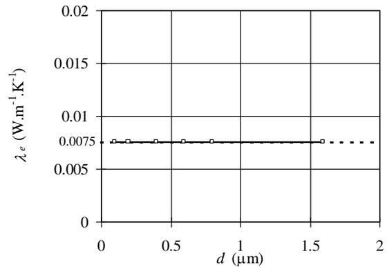
Figure 4 : Influence de la dimension caractéristique des pores
