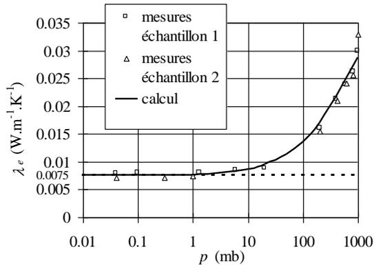
Figure 3 : Comparaison des conductivités apparentes mesurées et calculées
