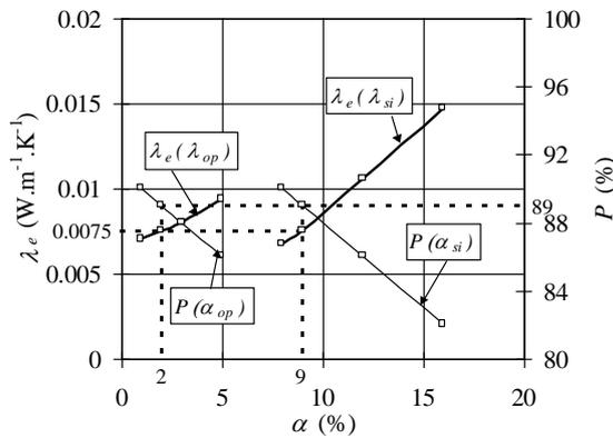
Figure 7 : Influence de la fraction volumique des particules
