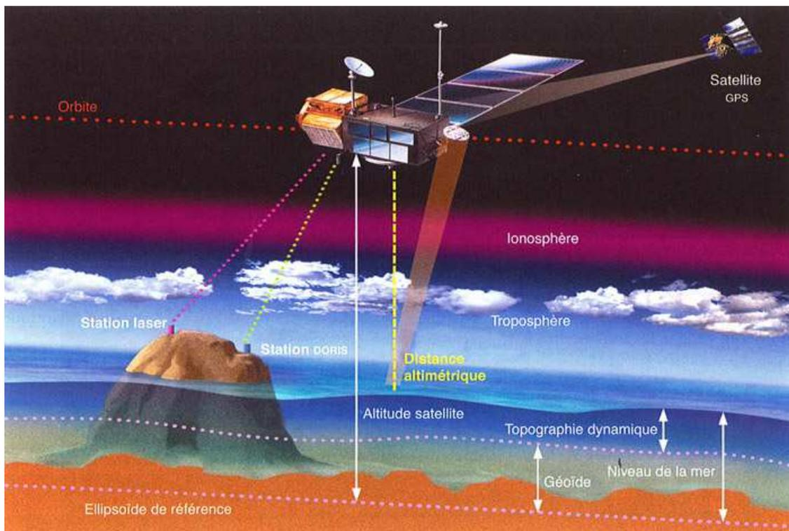
Figure II.2. Principe de l'altimétrie spatiale. Source : AVISO.
