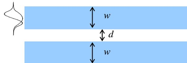
Figure 1. Vue de dessus du coupleur symétrique bimodal, constitué de deux guides d'onde identiques de largeur  $w$  à deux modes chacun, séparés par un interstice  $d$ .
