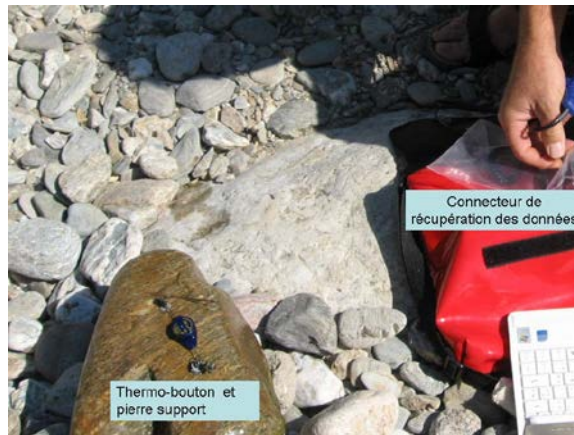
Photo 7- Thermo-bouton et dispositif de récupération des données.
