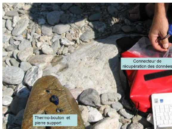
Photo 7- Thermo-bouton et dispositif de récupération des données.
