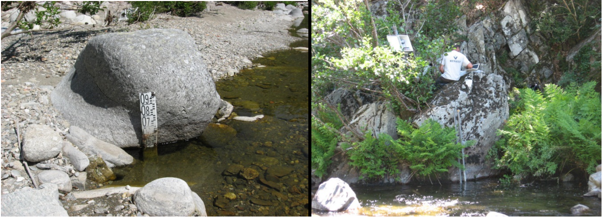
Photos 5 & 6- Echelle en rive gauche et enregistrement des hauteurs en rive droite - Gardon de St Jean à Peyrolles durant l'été 2012.
