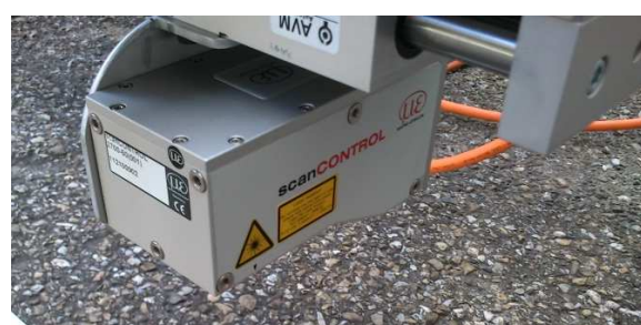
Figure 43 : Différentes vues du système – En haut : vue d'ensemble – En bas à gauche : table de positionnement transversal et mollette de positionnement latéral du capteur – En bas à droite : capteur laser
