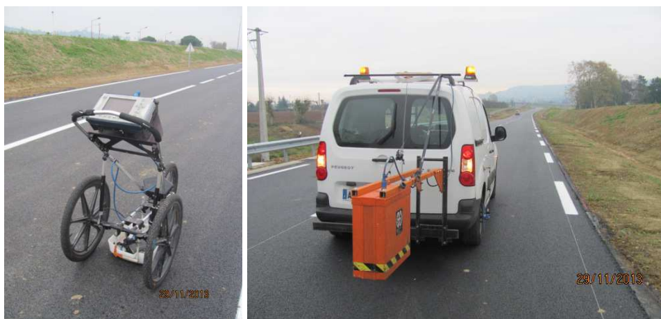
Figure 16 : Dispositifs de mesure des épaisseurs par imagerie RADAR
