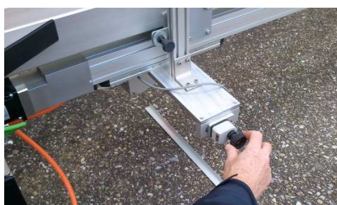
Figure 43 : Différentes vues du système – En haut : vue d'ensemble – En bas à gauche : table de positionnement transversal et mollette de positionnement latéral du capteur – En bas à droite : capteur laser
