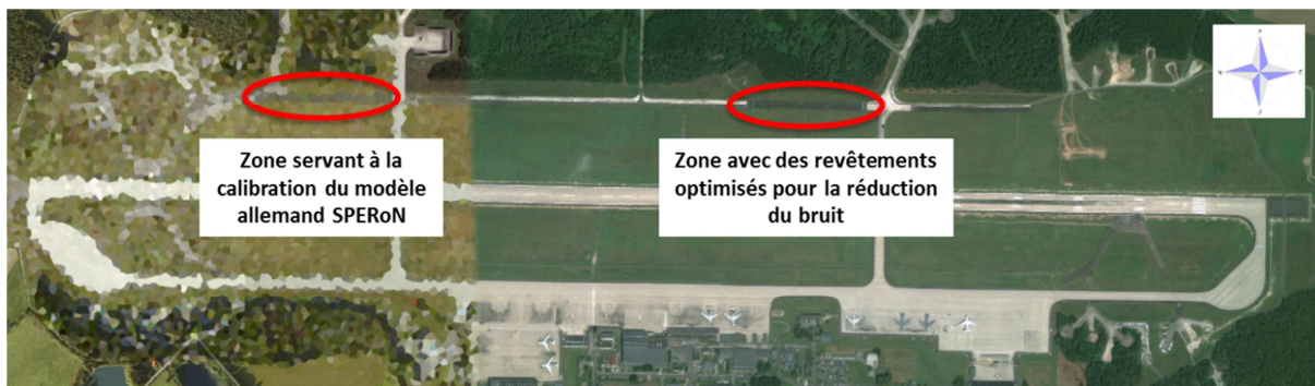
Figure 75 : Pistes d'essais de la BAST localisées sur la base aérienne de l'OTAN de Geilenkirchen en Allemagne
