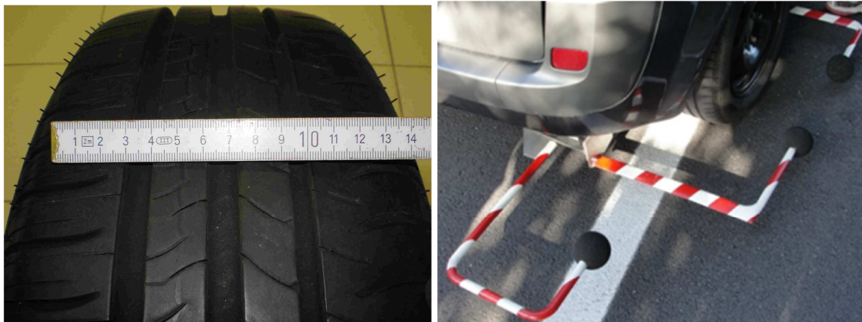
Figure 18 : Sculpture du pneumatique de mesure (gauche) et supports des microphones (droite)
