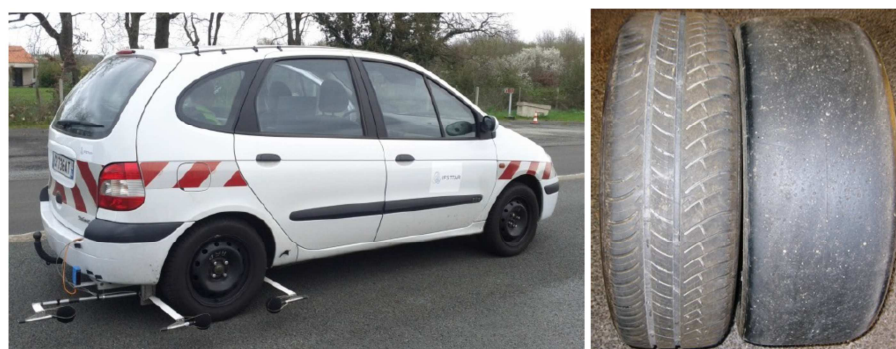
Figure 56 : Véhicule d'essai Renault Scénic utilisé pour les mesures de bruit de contact pneumatique/chaussée (à gauche) et les deux types de pneumatiques testés (standard ou lisse, à droite)
