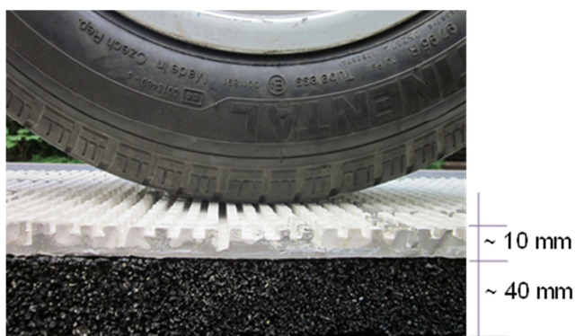
Figure 6 : Couche de matériau synthétique (en blanc) sur la couche poreuse (en noir)
