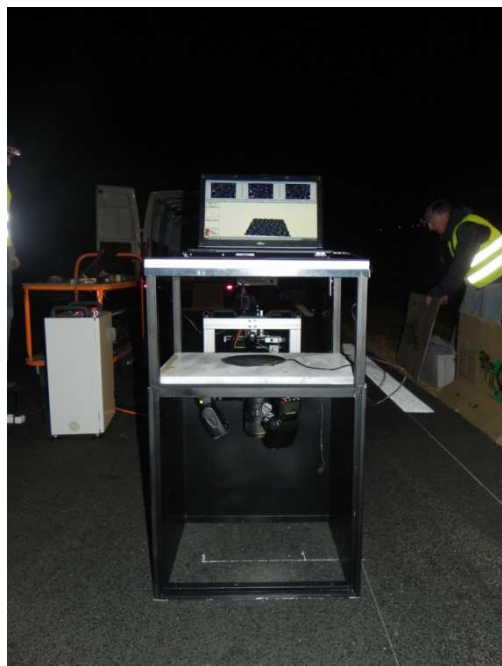
Figure 21: Dispositif de mesure de texture sur le site de la RD 911 (Villeneuve-sur-Lot)
