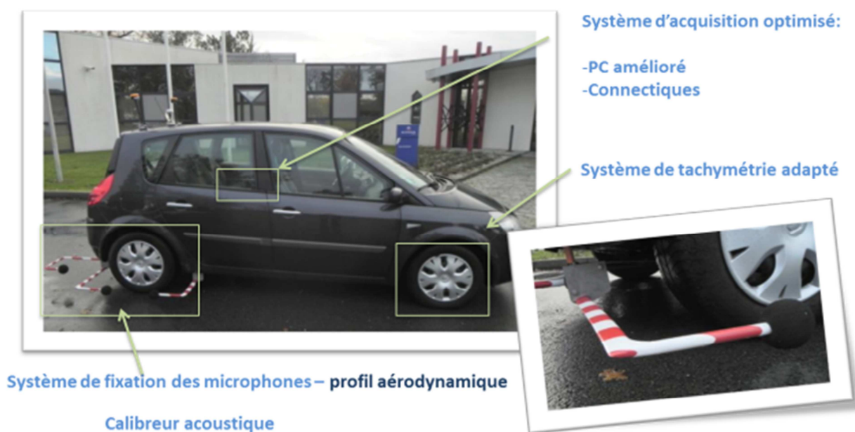
Figure 17 : Vue d'ensemble sur véhicule de mesure du bruit en champ proche EUROVIA
