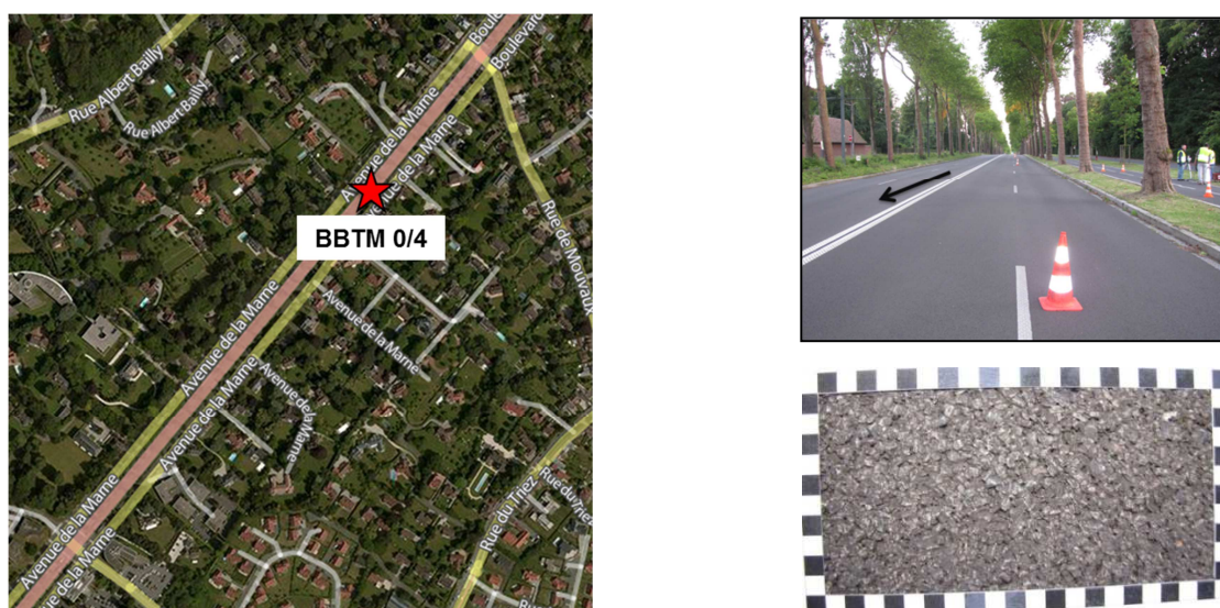
Figure 36 : Localisation du site de Mouvaux (gauche), site d'essai avec indication de la voie et du sens de mesure par une flèche noire (en haut à droite) et aperçu de la surface du BBTM 0/4 dans un cadre de 10 cm par 20 cm (en bas à droite)
