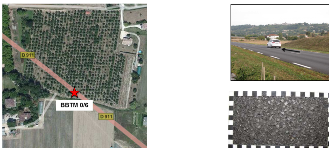
Figure 38 : Localisation du site de Villeneuve-sur-Lot (gauche), site d'essai avec indication de la voie et du sens de mesure par une flèche noire (en haut à droite) et aperçu de la surface du BBTM0/6 dans un cadre de 10 cm par 20 cm (en bas à droite)
