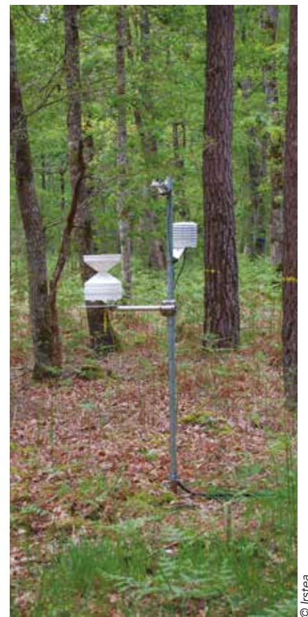
3 – Ensemble des capteurs pour les mesures du microclimat installés sur un mât
