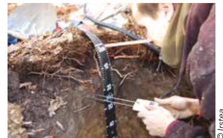
2 – Insertion d'un capteur d'humidité du sol à 20 cm de profondeur (type Campbell CS616)
