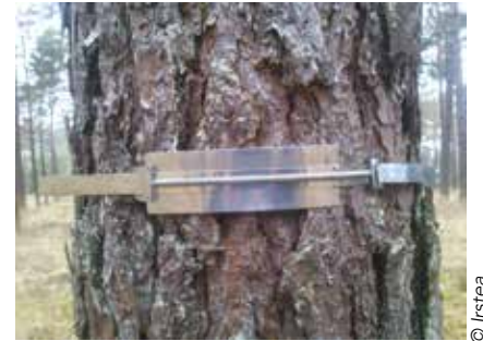
1 – Dendromètre installé sur un pin sylvestre
