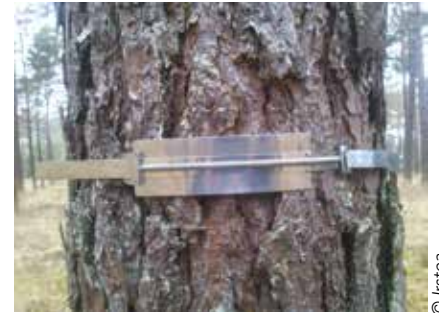
1 – Dendromètre installé sur un pin sylvestre
