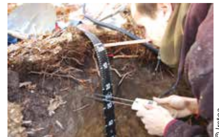
2 – Insertion d'un capteur d'humidité du sol à 20 cm de profondeur (type Campbell CS616)
