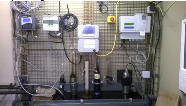
Figure 1 : Intérieur de la station de mesure avec le bac intermédiaire dans lequel sont plongés les différents capteurs.
