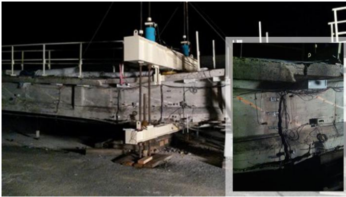
Figure 4 : Ruine de la poutre précontrainte par rupture en flexion.
