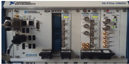
Système d'acquisition intégré à un châssis NI PXIe.
