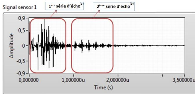
Structure des échos ultrasonores (a) échos au sein de la structure du capteur ; (b) réflexions sur la plaque combustible.
