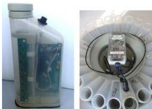
Figure 4 : a) Flacon instrumenté b) flacon dans le préleveur, bus et contrôleur CAN/interface USB.
