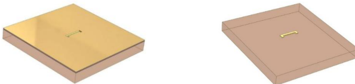
a) Dépôt de résine et métallisation b) Obtention des « underpass »
