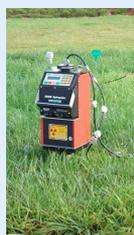
Suivi de l'humidité du sol à l'aide d'une sonde à neutron
