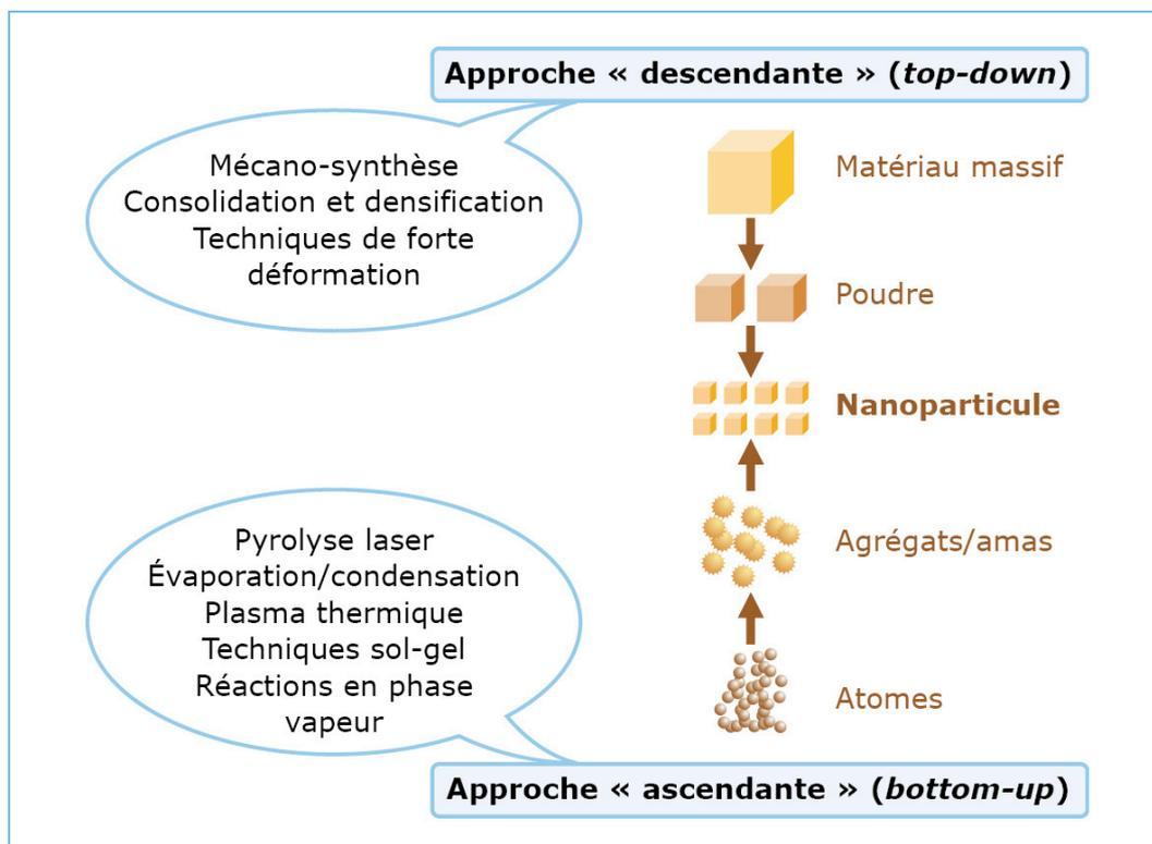
**Figure 3. Les deux approches d'élaboration des nanomatériaux manufacturés.**
