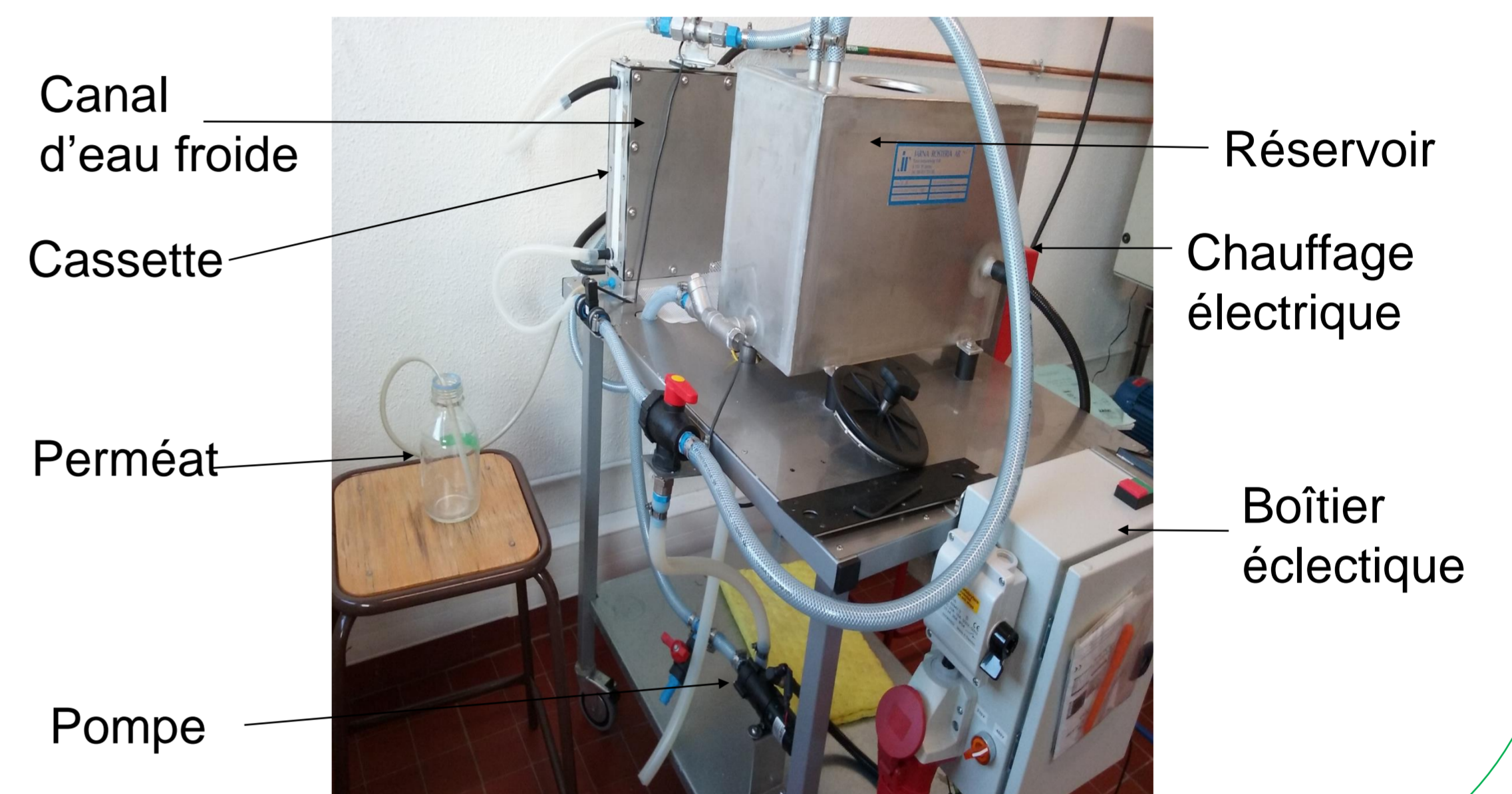
Figure 5 : Photographie du pilote AGMD
