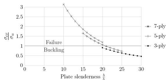
Rupture en compression du bois et charge critique de flambement sont du même ordre de grandeur : il est nécessaire de prendre en compte les deux phénomènes lors d'un dimensionnement de murs en CLT.
