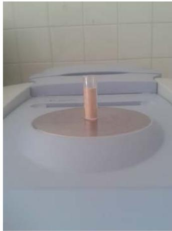
**Figure 12 : Analyse d'un échantillon au SPIR**
