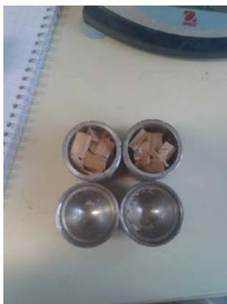
Figure 4 : Echantillon avant broyage
