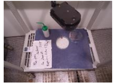
Figure 3 : Dispositif caméra : suivi de la germination
