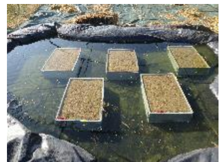
Figure 8 : Dispositif du stress inondation
