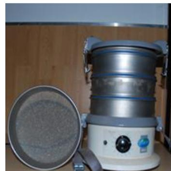
**Figure 10** : Tamiseuse utilisée au laboratoire
