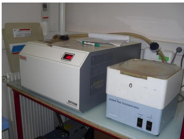
**Figure 18 : Système d'évaporation sous vide "Speed-Vac" (Savant, Speed-Vac SVC100H)**
