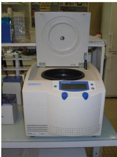
**Figure 17 : Centrifugeuse réfrigérée à 4°C**
