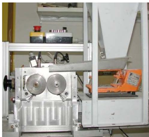
Figure 3 : Broyeur instrumenté pour la mesure des couples et énergies de fractionnement.
