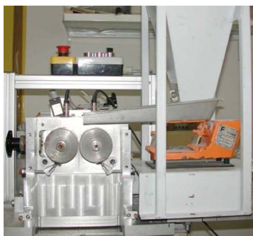
Figure 3 : Broyeur instrumenté pour la mesure des couples et énergies de fractionnement.
