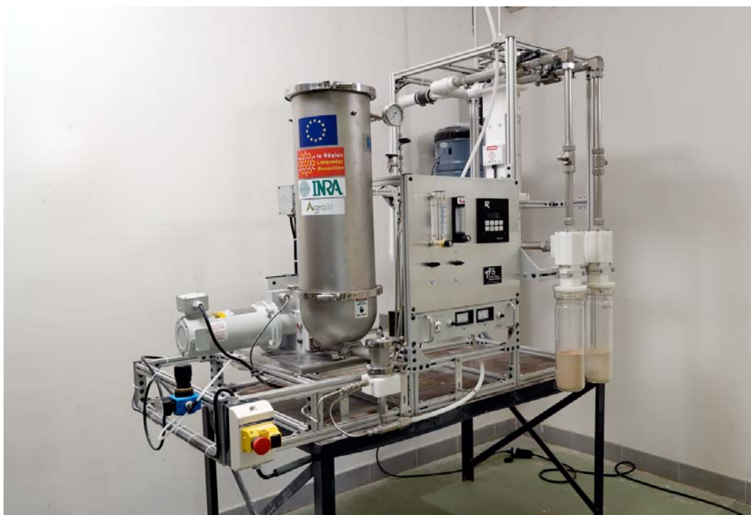
Figure 6. Équipement pilote de tri électrostatique de la plateforme de fractionnement des produits végétaux de l'INRA (Montpellier).
