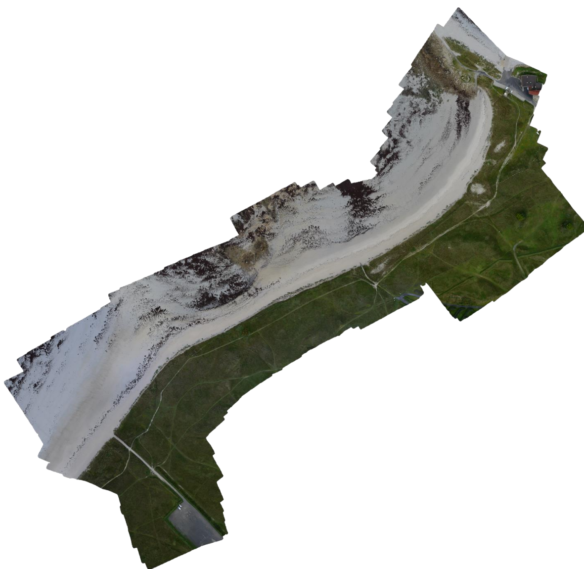
Figure 14 – Photographie aérienne à très haute résolution obtenues à partir d'un levé drone réalisé le 16 novembre 2015 par le LDO de l'UBO et le LST de Lyon.
