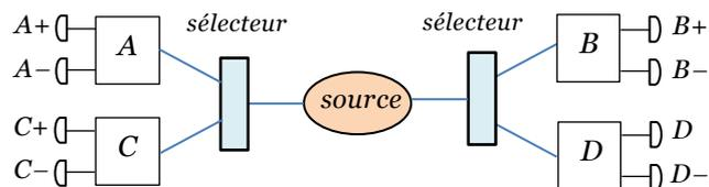
**Figure 2.** Configuration d'une expérience de Bell-CHSH avec deux photons polarisés.
