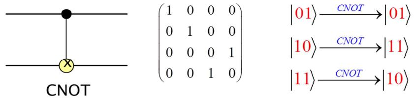
**Figure 4.** Porte quantique unitaire et réversible CNOT pour deux qubits.
