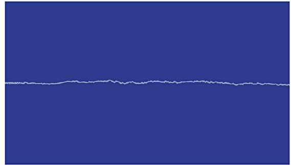
Fig. 4. Faciès de rupture d’un matériau homogène en traction. Fig. 4. Mode I crack propagation for an homogeneous media.
