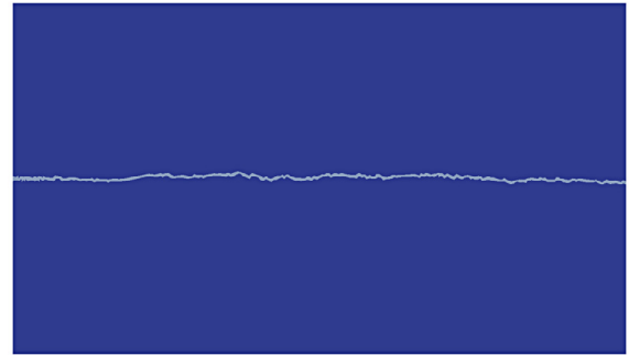
Fig. 4. Facies de rupture d’un matériau homogène en traction. Fig. 4. Mode I crack propagation for an homogeneous media.
