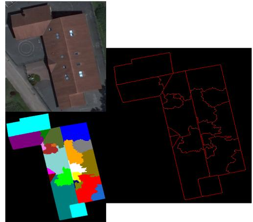
**Figure 6:** Exemple de caractérisation des arêtes des toitures (l'image initiale, l'image segmentée par LPE-régions et le modèle 2D correspondant).
