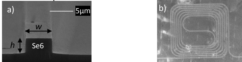
Fig. 2 : (a) Image de microscopie électronique à balayage (MEB) d'une section de guide d'onde en verres de chalcogénures (cœur en Se6 déposé sur une couche de Se2 pour la gaine). (b) Vue de dessus d'un guide ruban en forme de spirale obtenu au microscope optique.
