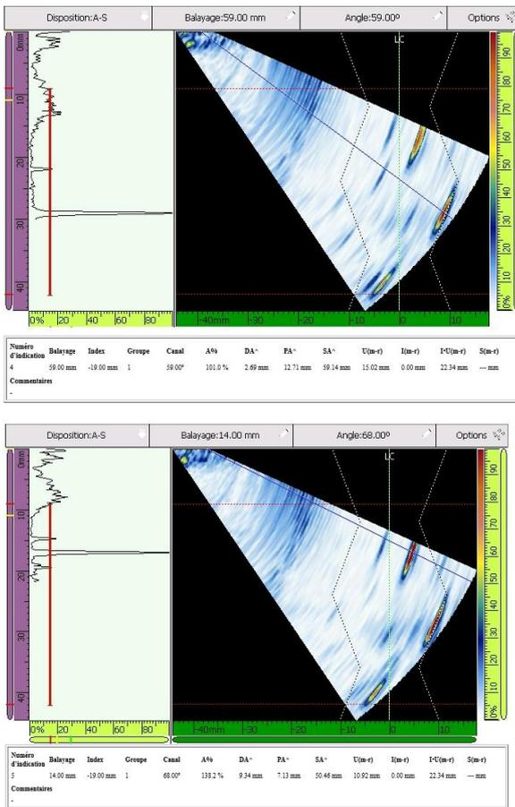
Le résultat du balayage angulaire présenté ci-dessus a été réalisé avec une ouverture de 16 éléments centrée sur la sonde 32 éléments.
