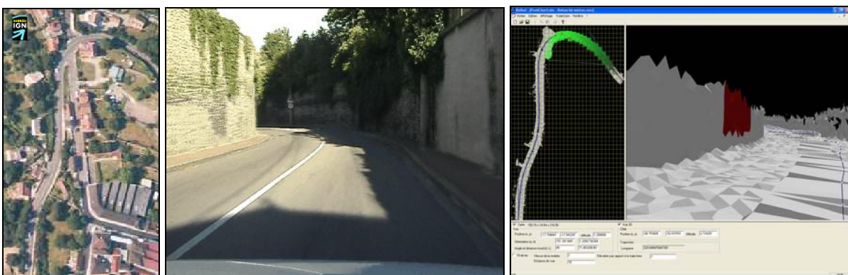
Figure 4 - A gauche, vue de dessus de l'itinéraire (RD 11, Yvelines) et vue embarquée (image LROP) ; à droite, modèle 3D avec un lancer de rayon rencontrant un mur dans le logiciel Ballad.
