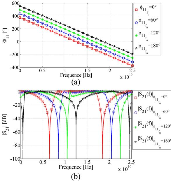
**Figure 3: (a) Variation de la phase en réflexion pour différentes valeurs de  $\varphi_{11f_0}$  ( $\Delta\varphi_{11} = 30^\circ / \text{GHz}$ ); (b) Spécifications associées sur l'amplitude en transmission.**
