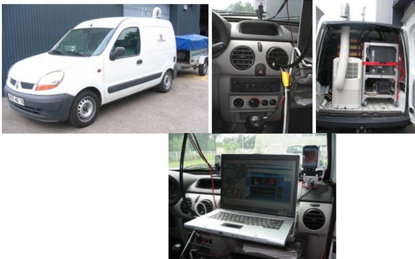
Figure 1 : Dispositif de mesure, de gauche à droite : (a) véhicule avec remorque pour l'alimentation, (b) prélèvement dans l'habitacle (c) climatisation et appareils de mesure (d) PC de contrôle et GPS
